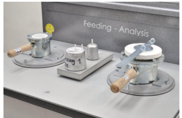
Das Gerät kombiniert Thermo-Analyse und Speisungs-Analyse
